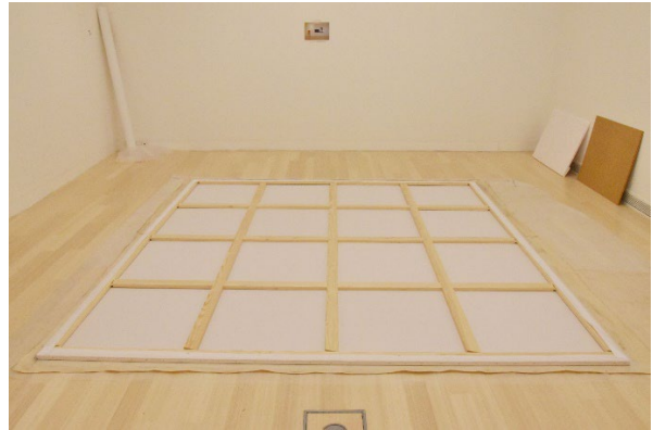
A vakkeret a felfeszített poliészter vászonnal a festményre helyezve
