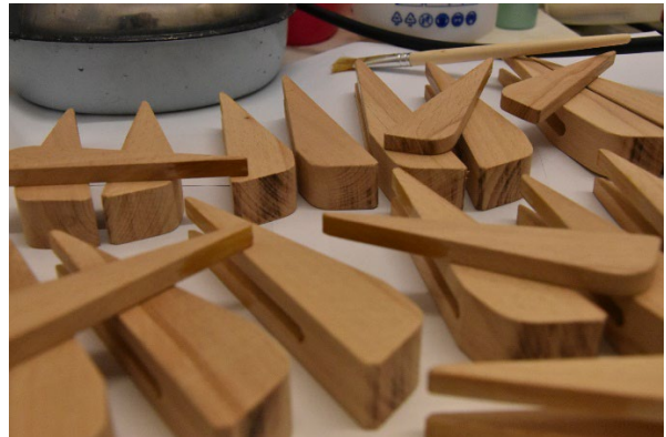
A vakkeret ékeinek a vakkerettel érintkező felületét viaszgyantával kentük be, hogy az ékek ne mozduljanak el a helyükről az ékelés után
